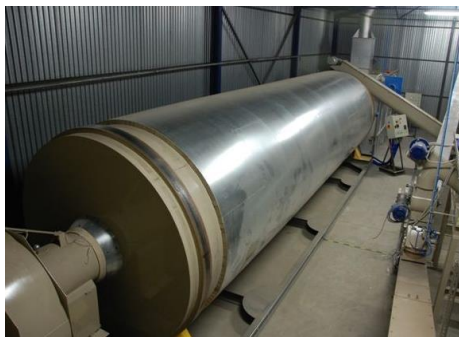
Ilustracija- Rotaciona sušara (Izvor: VALEX.hr)
