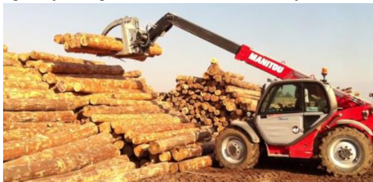
Ilustracija-Teleskopski utovarivač Manitou sa grajferom za trupce
